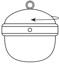
**1** Drehen Sie am Bajonettverschluss und vergewissern Sie sich, dass die Kugel verschlossen ist.
