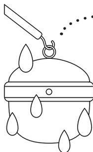
**9** Reinigen Sie die Kugel, indem Sie diese in einen Eimer mit heißem Wasser stellen oder sie unter fließendem warmem Wasser abspülen.
